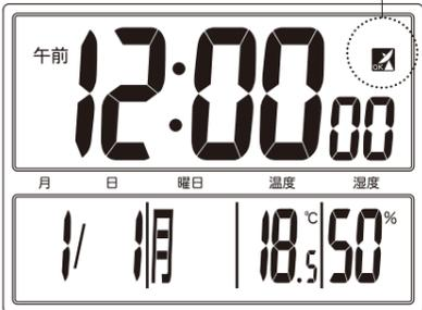
※電源投入直後およびリセットボタンを押した直後は、2007年1月1日 午前12:00に設定される。
