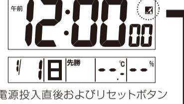
※電源投入直後およびリセットボタンを押した直後は、2012年1月1日、午前12:00に設定されます。
