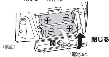
電池ふたを開けて、電池ホルダーの⊕⊖表示に合わせて、単3形乾電池を2個入れ、電池ふたを閉じてください。
