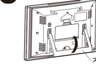
置いてご使用になるときは、スタンドを図のようにしてください。 ※無理な荷重を加えるとスタンドが外れたり、破損することがあります。 ※転倒を防ぐために、水平で安定したところに設置してください。
