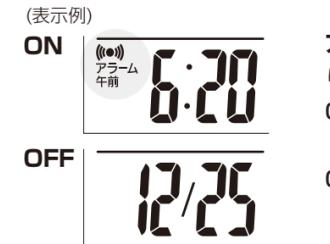
アラーム ON/OFF を押すとONとOFFが切り替わります。ON 設定時刻にアラームを鳴らす アラームマーク(●)を表示。 OFF 止める、鳴らさない アラームマーク(●)が消える。
