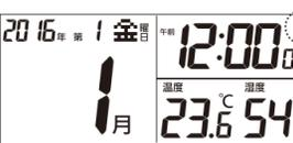
※電源投入直後およびリセットを押しした直後は、2016年1月1日、午前12:00に設定されます。
