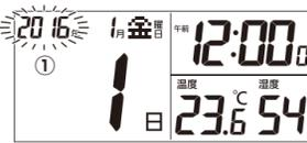
①時刻合わせ/表示切替を年(西暦)が点滅するまで約2秒間押し続ける。
