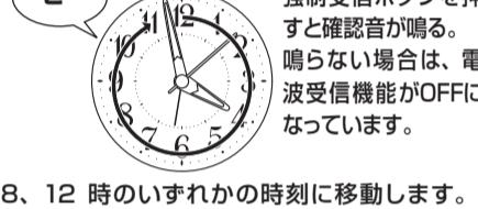
4、8、12時のいずれかの時刻に移動します。移動後、針が停止して受信を開始します。
