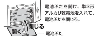
(裏面) 電池の⊕を逆向きに入れると、電池の発熱・破裂・液もれの原因になります。
