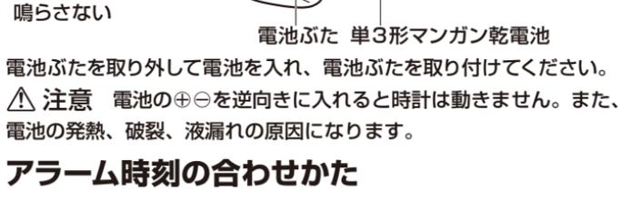
電池ふたを取り外して電池を入れ、電池ふたを取り付けてください。
