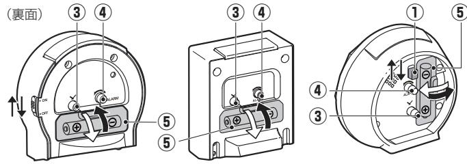
単3形乾電池 1個 電池ぶた ⇩取り外す ⇩取り付ける
