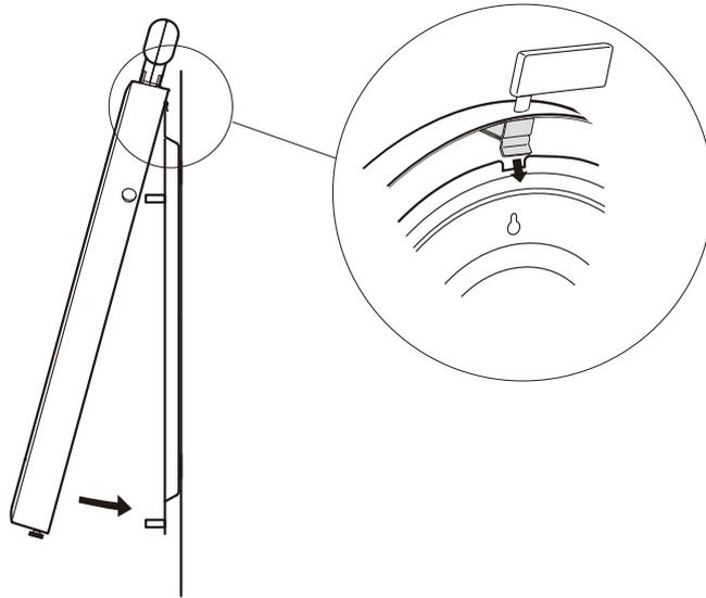
(2) 時計体を裏ぶたにきちんとかぶせ、3カ所の止めねじを全体が均等になるように順に締めて、最後にねじが緩まないようにきつく締めます。
