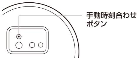
手動時刻合わせボタンを押すと、時刻の修正モードになり、針が動き始めます。
