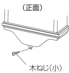
扉の開閉時に時計が傾くのを防止するため、時計裏面の振れ止めを左図のようにしてから垂直に掛け、木ねじ（小ねじ）で固定してください。
