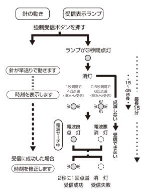
電波サーチ機能は、受信表示ランプの点 灯または消灯により、時計がある場所の電 波状態をお知らせします。
