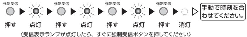
※電波受信機能がOFFのときに強制受信ボタンを押すと、受信表示ランプは消灯したままで、針が早送りや動いたり、止まったりしてから時刻を表示します。
