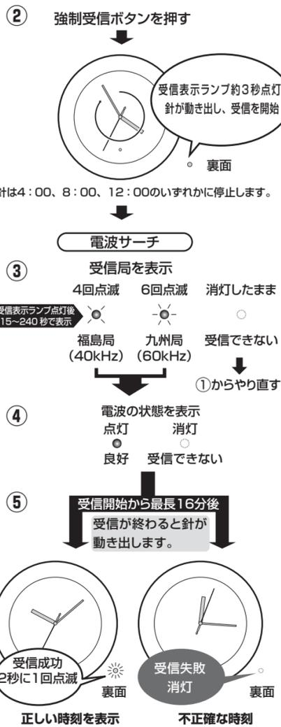
電波サーチ機能は、受信表示ランプの点灯または消灯により、時計がある場所の電波状態をお知らせします。
