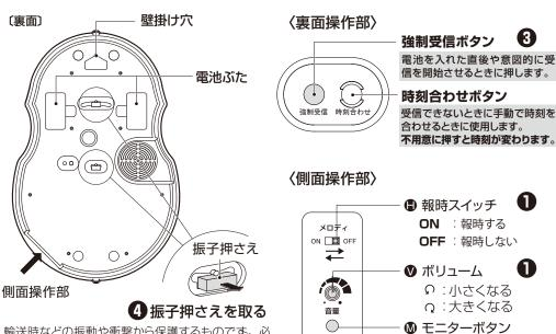
輸送時などの振動や衝撃から保護するものです。必 ず、使用するときは取り外し、輸送する際は取り付 けてください。
