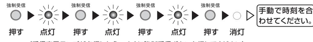
（受信表示ランプが点灯したら、すぐに強制受信ボタンを押してください）
