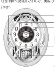
受信表示ランプ 時針 (短い針) 分針(長い針) 雷油ランプ 2秒に1回赤色点滅し たら電池を交換する。 明暗センサー 回転飾り
