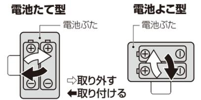
時計裏面の電池ぶたを外し、電池ホルダーの⊕⊖表示に合わせて単3形乾電池を2個入れ、電池ぶたを取り付けます。
