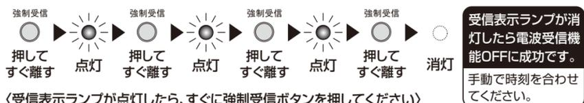
〈受信表示ランプが点灯したら、すぐに強制受信ボタンを押してください〉
