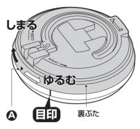
裏ぶたを取る 白矢印(左)方向に回す 時計を水平にして、裏ぶたをOPEN方 向に各の▼印を 目前 まで回して外し ます。
