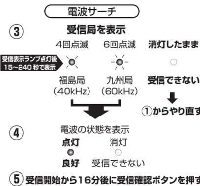
電波サーチ機能は、受信表示ランプの点灯または消灯により、時計がある場所の電波状態をお知らせします。
