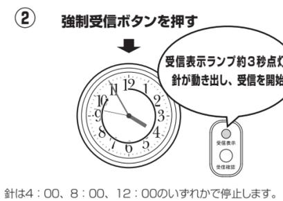
電波サーチ機能は、受信表示ランプの点灯または消灯により、時計がある場所の電波状態をお知らせします。
