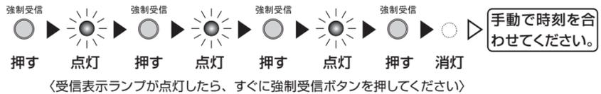
※電波受信機能がOFFのときに強制受信ボタンを押すと、受信表示ランプは消灯したままで、針が早送りや遅送り、止まったりしてから時刻を表示します。
