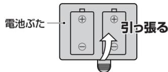
**注意** 電池の⊕⊖を逆にすると、電池の液漏れ・発熱・破裂の原因となります。
