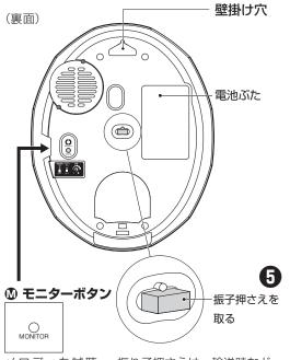
振り子押さえは、輸送時など メロディを試聴 するときに押す。 の振動や衝撃から保護するた めのものです。ご使用になる ときは取り外し、輸送すると きは取り付けてください。
