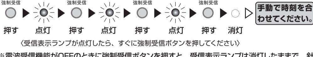
（受信表示ランプが点灯したら、すぐに強制受信ボタンを押してください）
