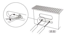
左図のように、装飾用の重すいを時計 底部の金具に取り付けてください。
