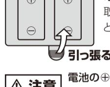
△ 注意 電池の $\oplus\ominus$ を逆に入れると、電池の液漏れ・発熱・破裂の原因となります。
