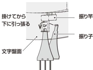
振り子を取り付けにくいときは、時計を掛ける前に振り子を取り付けてください。
