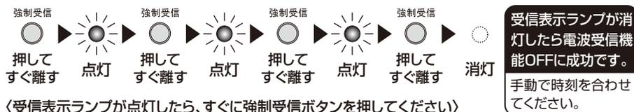
※電波受信機能がOFFのときに強制受信ボタンを押すと、受信表示ランプは消灯したままで、針が早送りで動いたり、止まったりしてから時刻を表示します。
