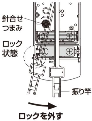
ロックが外れにくいときは、少し強めに矢印方向に押しください。使用するときにはロックを外し、輸送する際はロックしてください。
