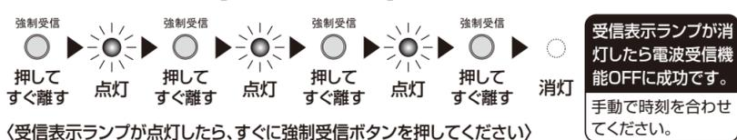
〈受信表示ランプが点灯したら、すぐに強制受信ボタンを押してください〉
