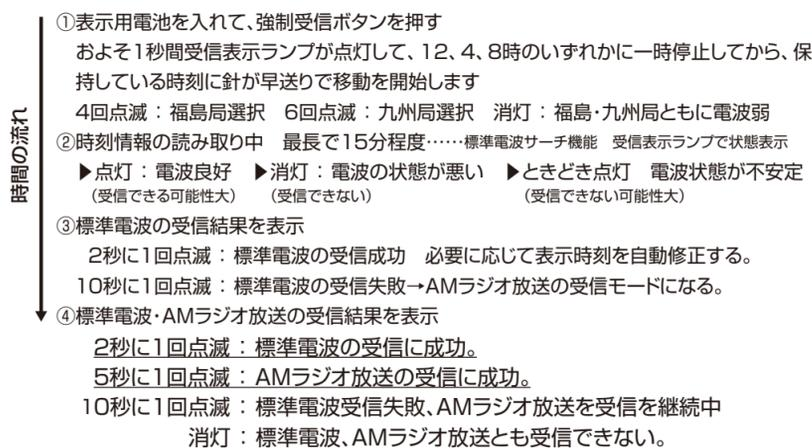
\*AMラジオ放送の受信は標準電波が受信できないときに行います。受信状態になってから連続7日間受信できないときは、AMラジオ放送の受信を停止します。
