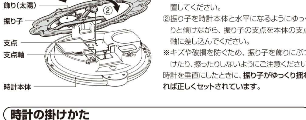
①振り子を斜めにして、左図のように振り子の上部を太陽の飾りの下にくぐらせるように配置してください。
