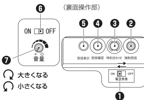
①電波受信スイッチ ..... 電波受信機能のON/OFF切り替え
