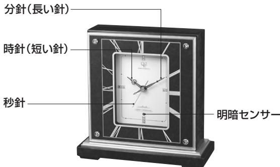
明暗センサーは明るさを感じ、暗くなると秒針を12時位置に止め、報時スイッチが自動消音のときには報時を止めます。昼間や夜間照明時でも明るさが不足すると明暗センサーが反応します。
