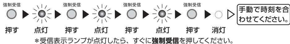
※電波受信機能がOFFのときに**強制受信**を押すと、**受信表示**は消灯したままで、針が早送りで動いたり、止まったりしてから時刻を表示します。
