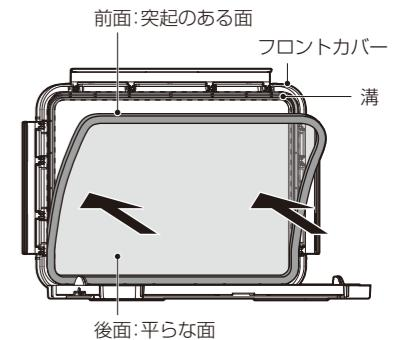
② 操作シートの枠全周をフロントカバーに押し込んで、確実に固定させてください。
