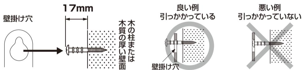
△ 注意 時計の壁掛け部以外に掛け具(ねじ)を掛けないでください。時計の落下により、物品の損傷やけがの原因になります。
